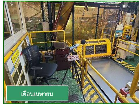
ภาพที่ 3.55 การตรวจวัดระดับเสียงในสถานที่ทำงานบริเวณ Inspection RCL Delivery
