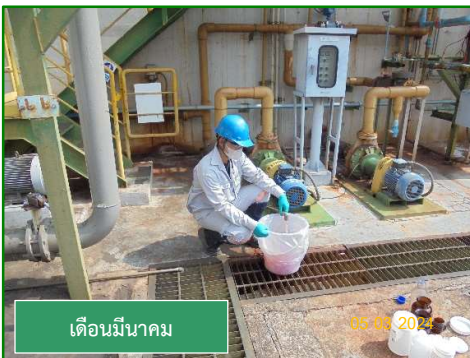
ภาพที่ 3.25 การตรวจวัดคุณภาพน้ำจุด Weak Acid Wastewater Treatment Plant (บ่อกรด)
