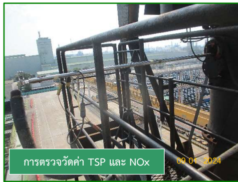
ภาพที่ 3.4 การตรวจวัดคุณภาพอากาศจากปล่อง ARP
