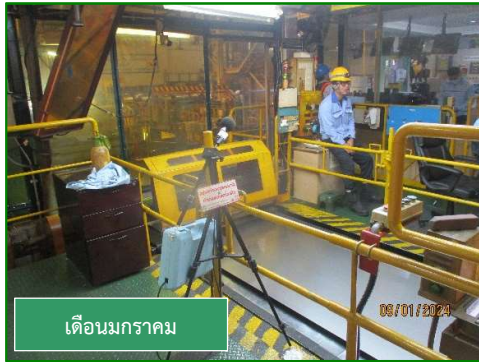
ภาพที่ 3.55 การตรวจวัดระดับเสียงในสถานที่ทำงานบริเวณ Inspection RCL Delivery
