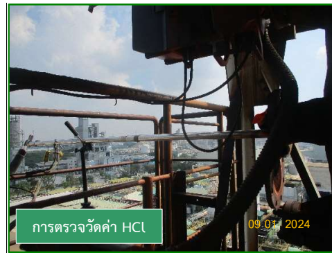
ภาพที่ 3.4 การตรวจวัดคุณภาพอากาศจากปล่อง ARP
